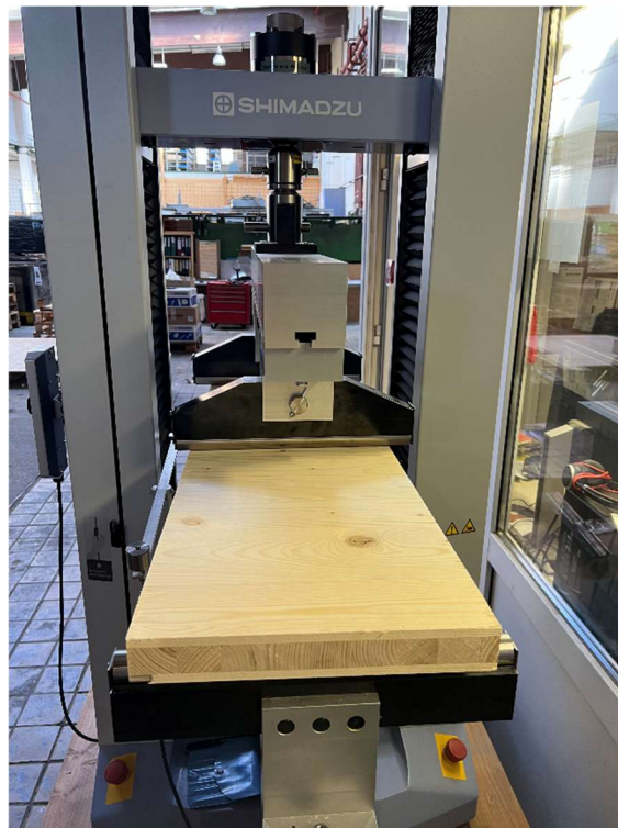
Obr. 1: Shimadzu AGS-X 50kN pro zkoušení mechanických vlastností desek dle EN 789
